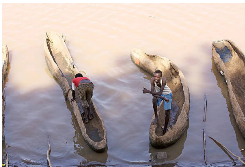
Barques éthiopiennes creusées dans des troncs d'arbres. Leur forme est dictée par la forme de l'arbre, donnant parfois des barques incurvées, à la navigation plus complexe.
